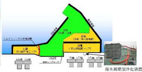
図4：港湾内海底土の被覆等イメージ
