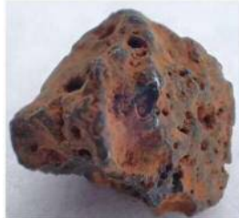
大きさ：約5mm×約4mm 重量：0.187g 線量率（γ線）：約0.3mSv/h
