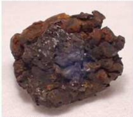
大きさ：約9mm×約7mm 重量：0.693g 線量率（γ線）：約8mSv/h
