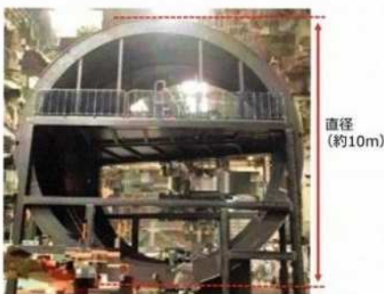
圧力抑制室の実機模型
